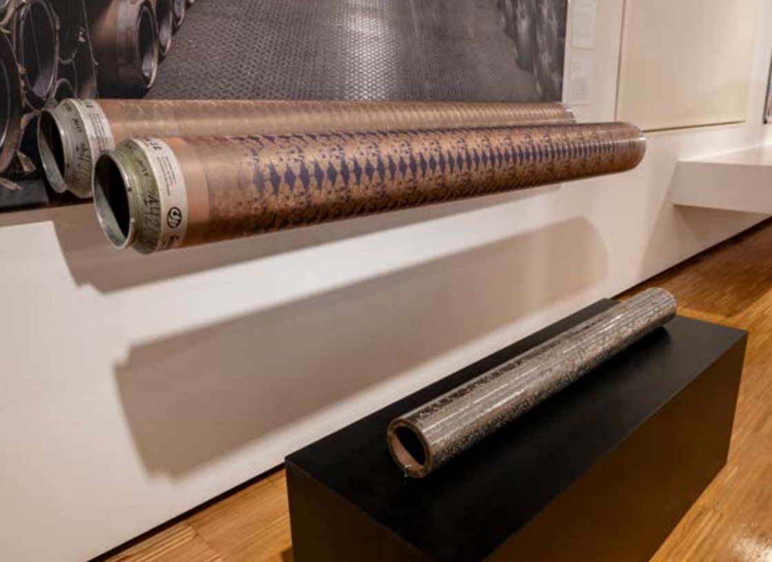
Cilindre de coure, c. 2000. Coure, gravat i cromat. Cilindres de rotativa, c. 2020. Níquel i alumini, microperforat. Col·lecció Estampunt, SL
