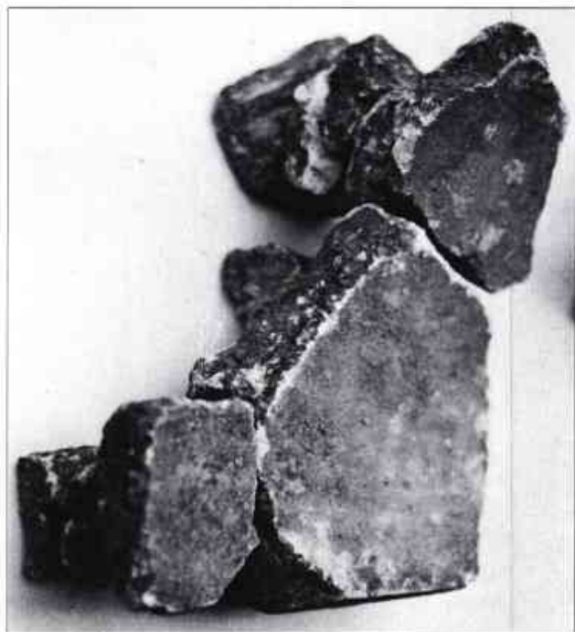
Fig. 10: Fragments de l'arrencament de la volta, amb la zona plana formant angle.
